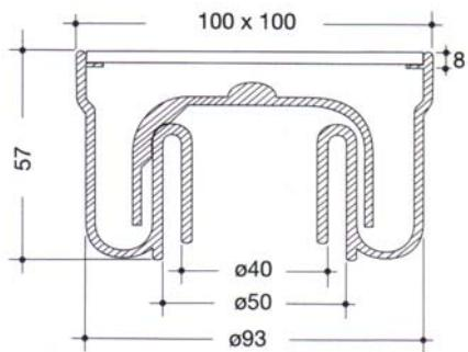
Тялото на сифоните за мокри помещения е произведено от поливинилхлорид (PVC), с вертикални изходи ф 50/40 мм и ф 100. Свързването на сифона с канализационните тръби се осъществява чрез лепене, при което се осигурява отлична водопътност на системата. Допълнителна част от комплекта е фабрична капачка, която създава водна риза. Естетичен завършек на системата са двата модела решетки – PVC в бял цвят и инокс. Размерът на решетките е 10 x 10 см.
